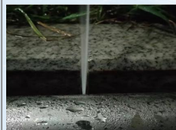
DN100铸铁管 圆孔泄漏
